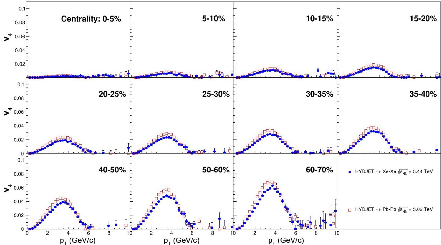
Результаты для  $v_4$ , полученные в генераторе HYDJET++ относительно истинной плоскости реакции (статистика ок. 1 млн. событий для каждой центральности).
